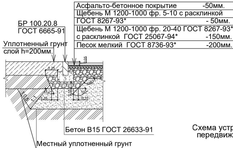
Схема устройства занижения бортового камня для передвижения маломобильных групп населения
